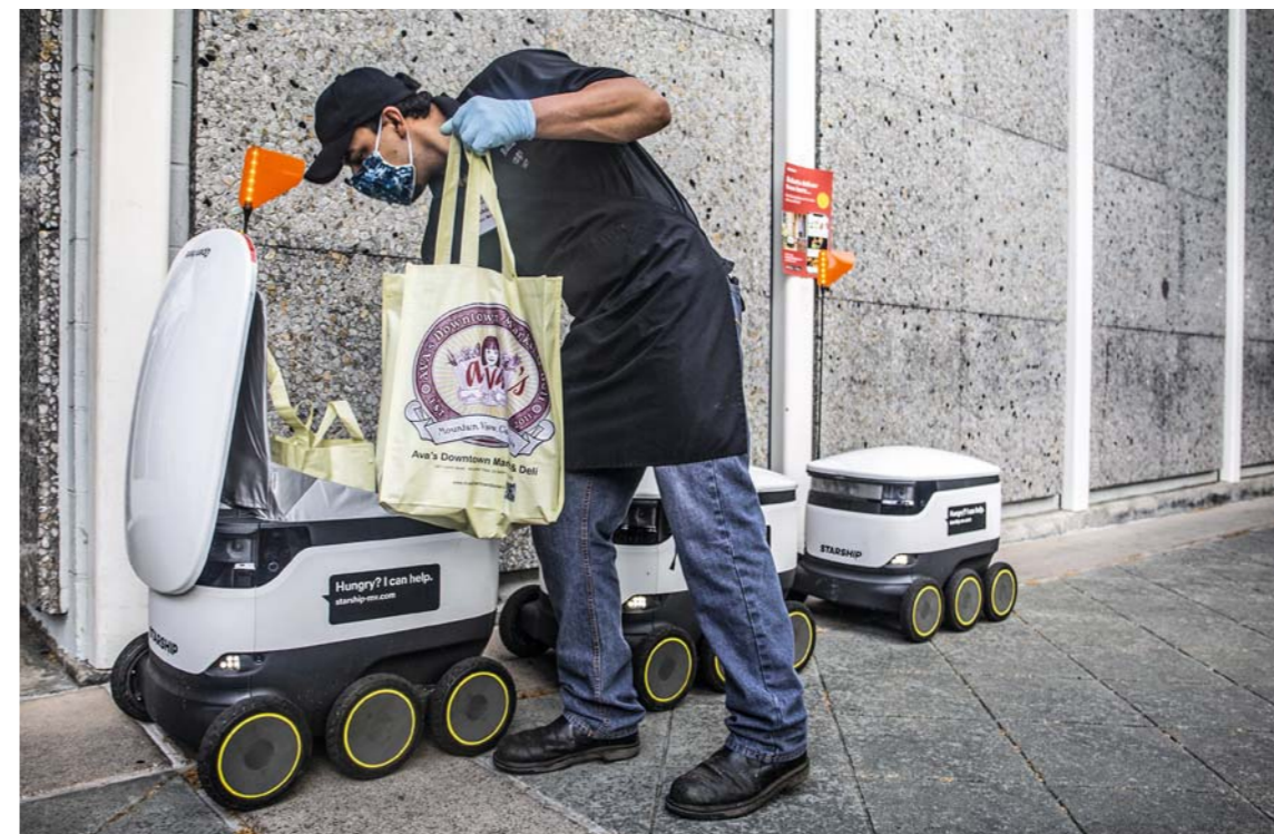
Ein Mitarbeiter der kalifornischen Firma Starship Technologies belädt einen Roboter, der die Ware selbstständig ausliefert
